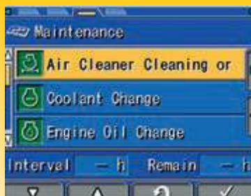
Monitor multifunzione per fornire all'operatore informazioni sullo stato di manutenzione
