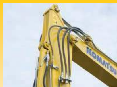
Linea idraulica, a una o due vie, standard per le attrezzature e linea idraulica per attacco rapido di serie
