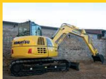
Il ridotto raggio di rotazione anteriore e la funzione di rotazione del primo braccio semplificano notevolmente lo scavo di fossi
